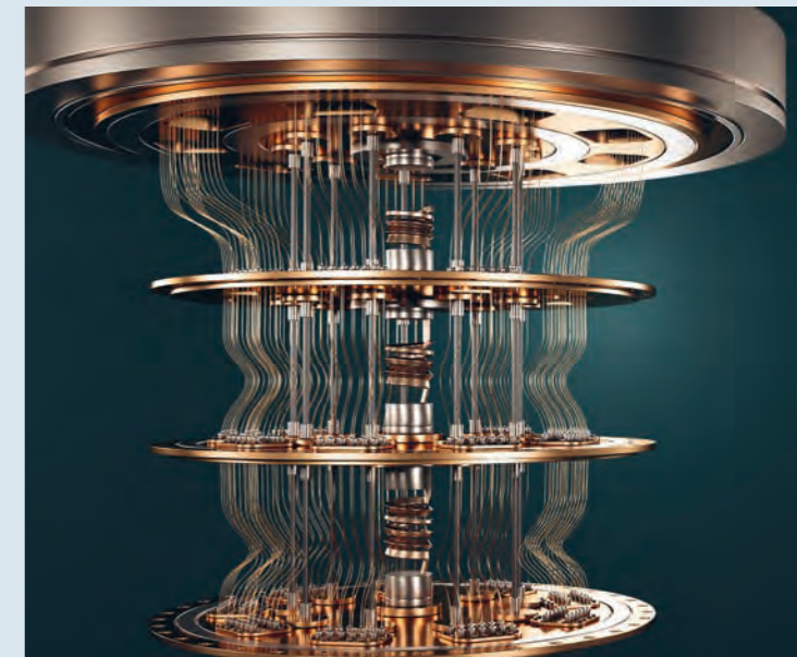
RÉFRIGÉRATEUR À DILUTION POUR LA RÉALISATION D'UN PROCESSEUR QUANTIQUE.
