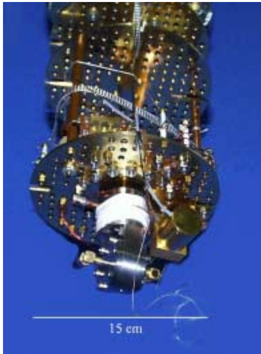
Thermomètre acoustique et thermomètre à pression de fusion de l'hélium-3 montés sur une platine du réfrigérateur à dilution
