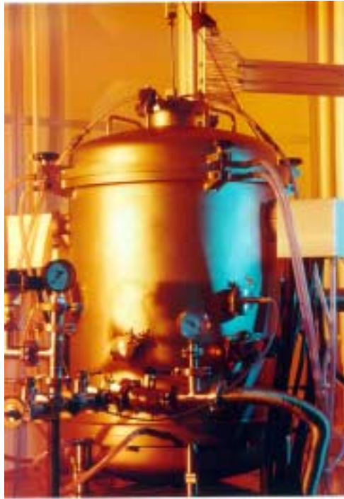
Four haute température 2 000 °C
