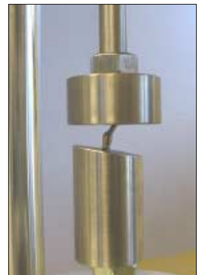
Essai d'endurance sur implant dentaire
