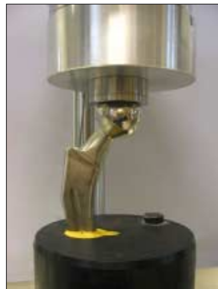
Essai d'endurance sur tige de prothèse de hanche
