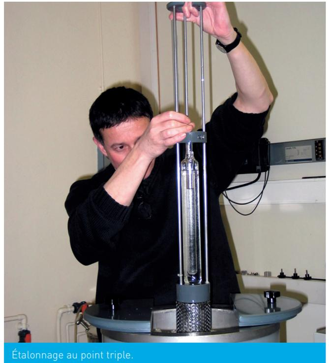
Étalonnage au point triple.
