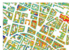
Thermographie des toitures (après extraction du bâti), intégrable dans le SIG de la collectivité
