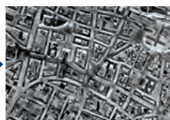
Thermographie en niveaux de gris (après correction géométrique des images par modélisation mathématique)
