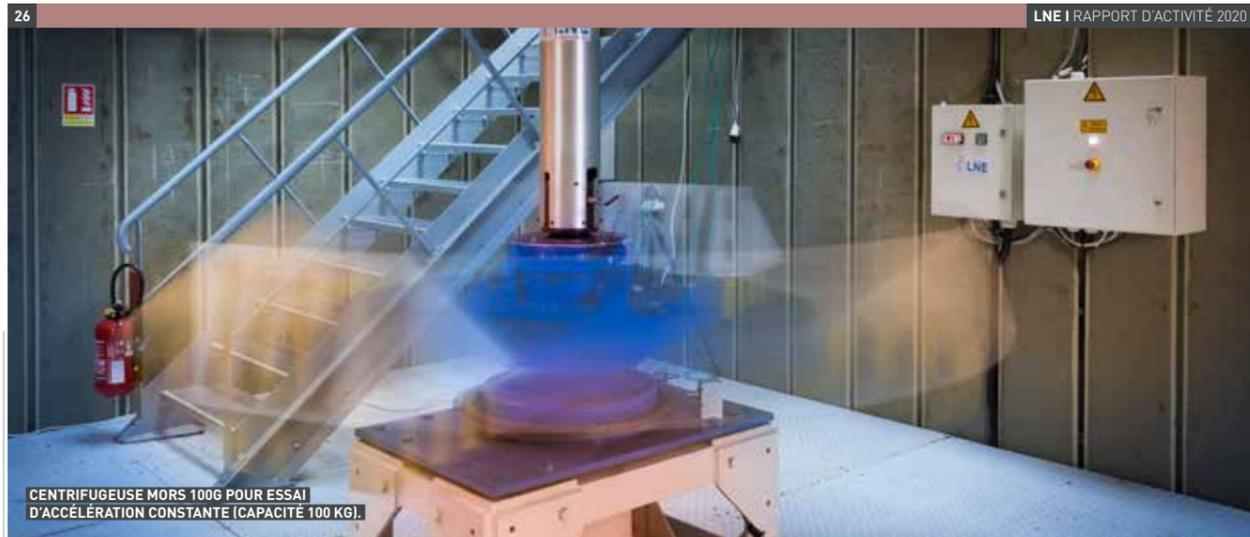
CENTRIFUGEUSE MORS 100G POUR ESSAI D'ACCÉLÉRATION CONSTANTE (CAPACITÉ 100 KG).
