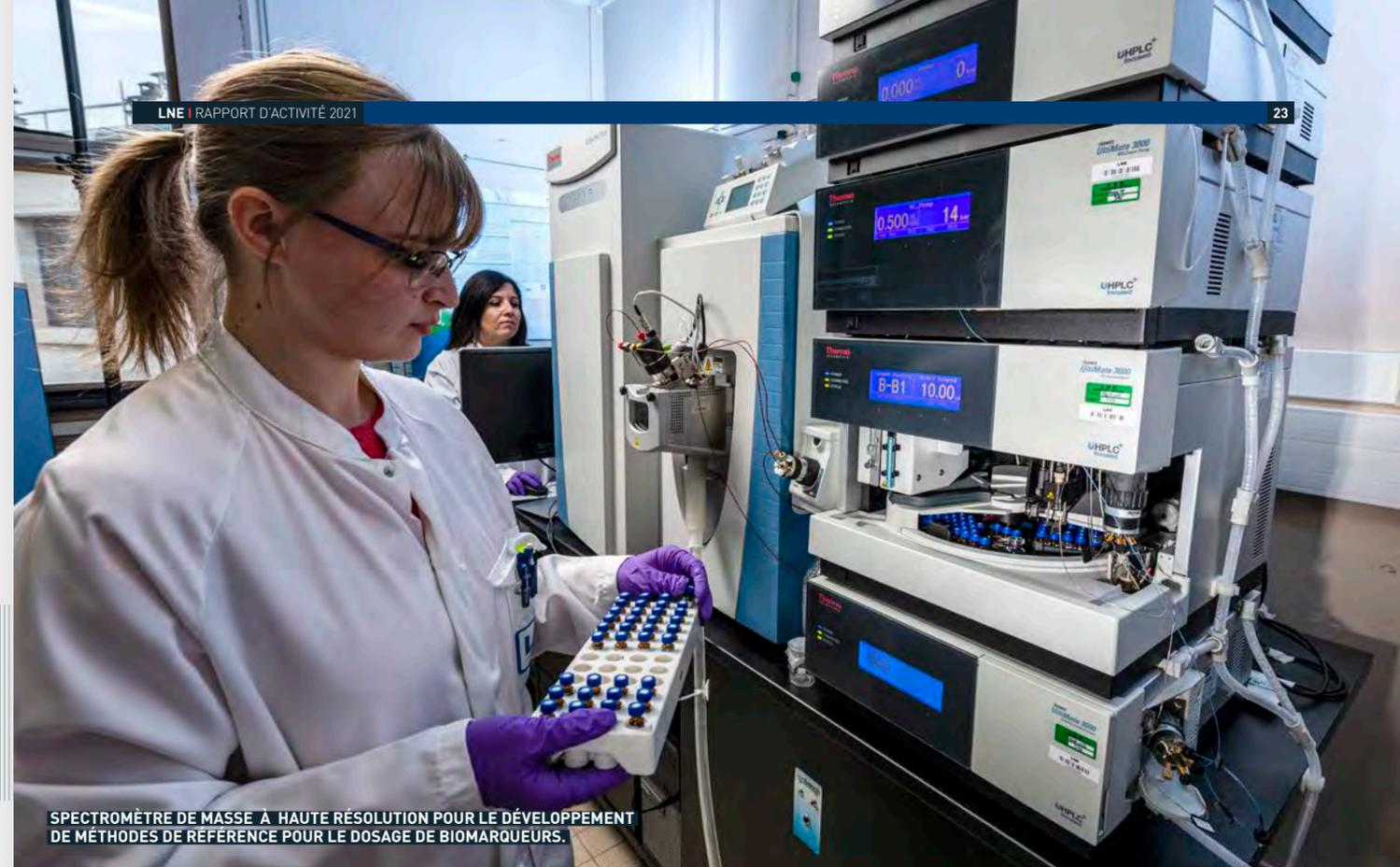
SPECTROMÈTRE DE MASSE À HAUTE RÉOLUTION POUR LE DÉVELOPPEMENT DE MÉTHODES DE RÉFÉRENCE POUR LE DOSAGE DE BIOMARQUEURS.
