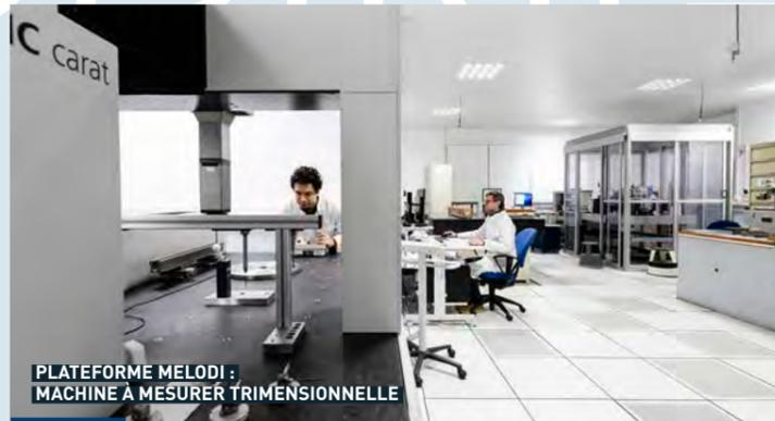
PLATEFORME MELODI : MACHINE À MESURER TRIDIMENSIONNELLE
