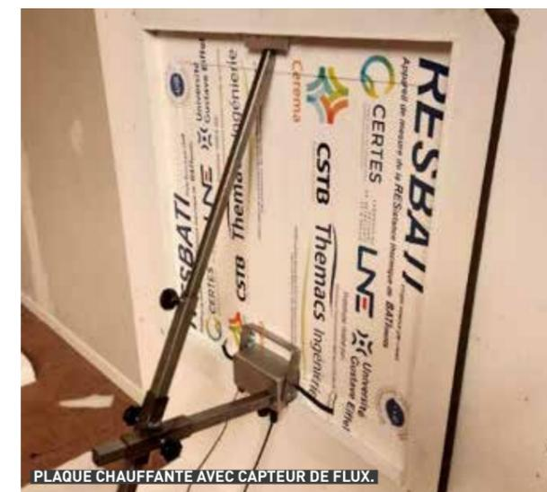
PLAQUE CHAUFFANTE AVEC CAPTEUR DE FLUX.
