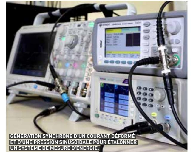
**GÉNÉRATION SYNCHRONE D'UN COURANT DÉFORMÉ ET D'UNE PRESSION SINUSOÏDALE POUR ÉTALONNER UN SYSTÈME DE MESURE D'ÉNERGIE.**
