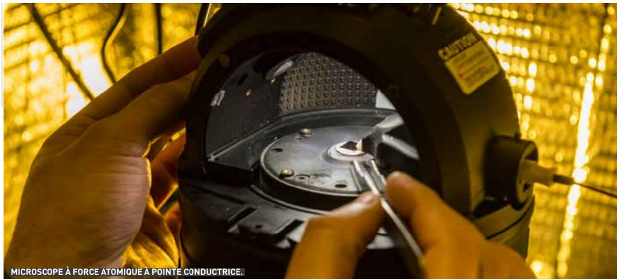
MICROSCOPE À FORCE ATOMIQUE À POINTE CONDUCTRICE.
