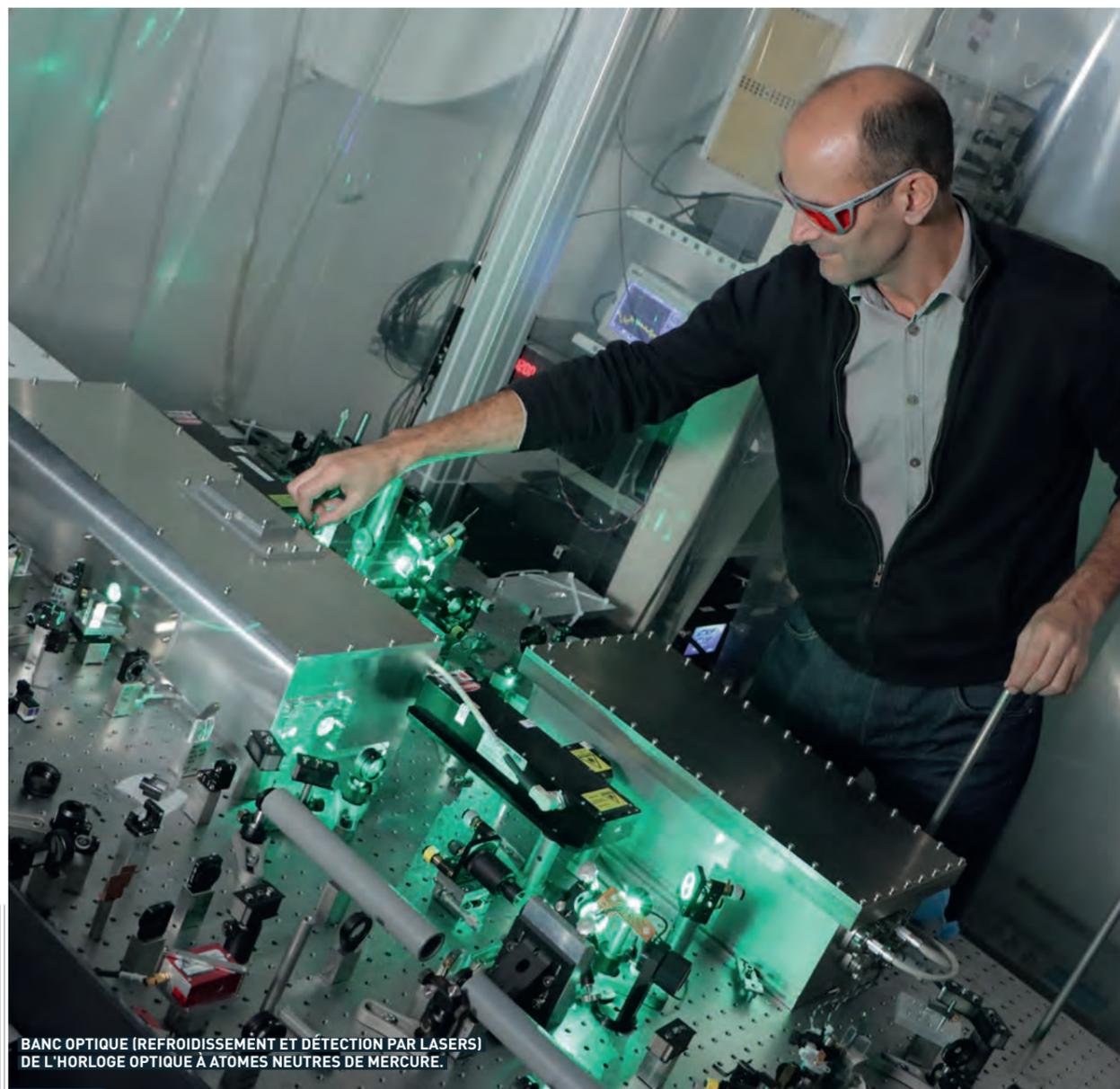
BANC OPTIQUE (REFROIDISSEMENT ET DÉTECTION PAR LASERS)
