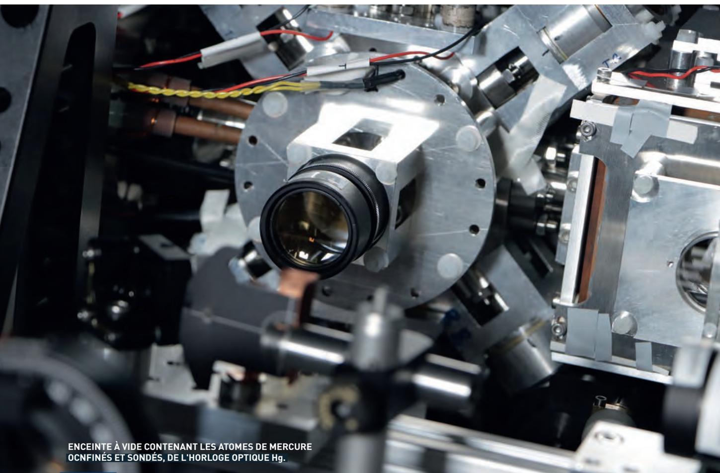
ENCEINTE À VIDE CONTENANT LES ATOMES DE MERCURE OCNFINÉS ET SONDÉS, DE L'HORLOGE OPTIQUE Hg.
