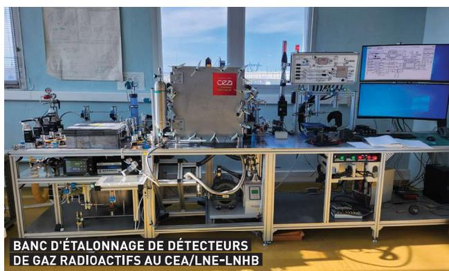
**BANC D'ÉTALONNAGE DE DÉTECTEURS DE GAZ RADIOACTIFS AU CEA/LNE-LNHB**
