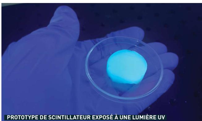
**PROTOTYPE DE SCINTILLATEUR EXPOSÉ À UNE LUMIÈRE UV**
