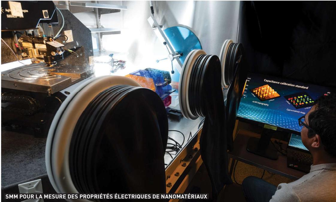
SMM POUR LA MESURE DES PROPRIÉTÉS ÉLECTRIQUES DE NANOMATÉRIAUX
