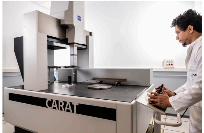
Plateforme MELODI : machine à mesurer tridimensionnelle Zeiss.
