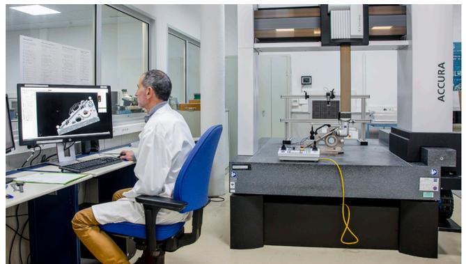
Machine à mesurer tridimensionnelle ZEISS à tête mesurante orientable pour scanning en continu avec et sans contact.
