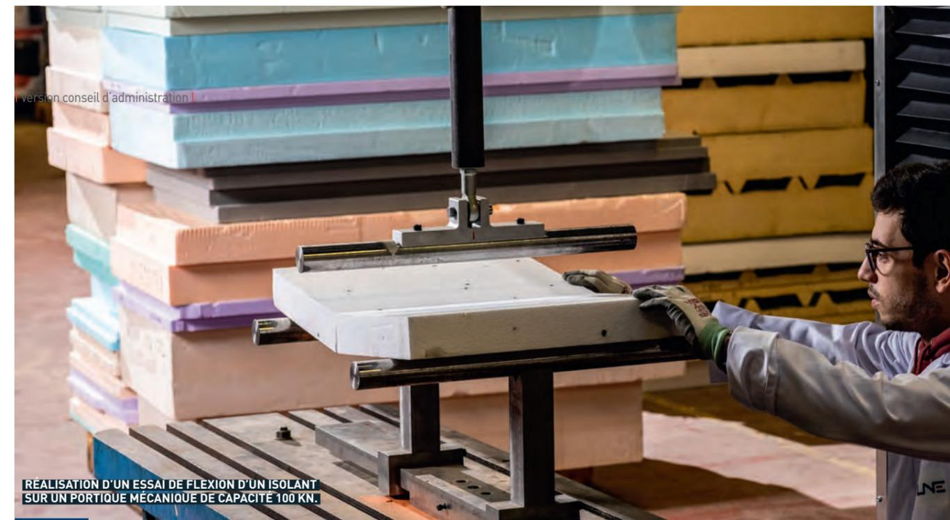
RÉALISATION D'UN ESSAI DE FLEXION D'UN ISOLANT SUR UN PORTIQUE MÉCANIQUE DE CAPACITÉ 100 KN.
