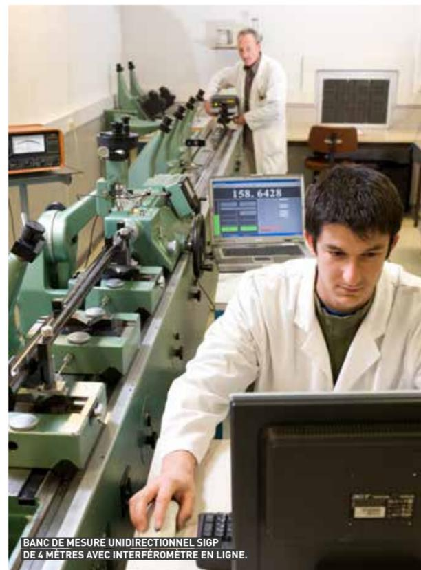
BANC DE MESURE UNIDIRECTIONNEL SIGP DE 4 MÈTRES AVEC INTERFÉROMÈTRE EN LIGNE.
