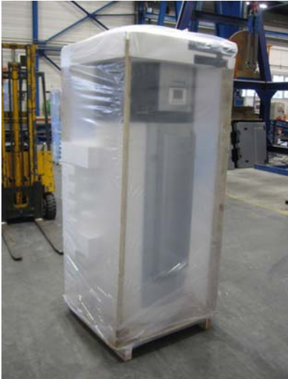
Essais de simulation de transport d'un chauffe-eau thermodynamique emballé sur palette.
