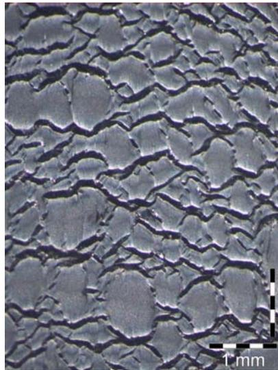
*PE 100 RD : aspect de la surface interne de l'éprouvette suite à un test de rupture, après 500 heures de vieillissement.*
