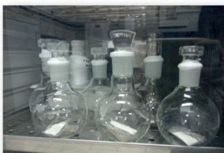
Dispositif expérimental représentant un simulant alimentaire emballé dans un sac en PP biorienté et un carton dopé avec des solutés sans contact direct.
