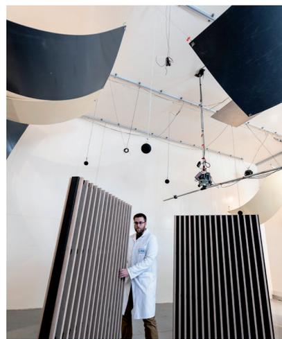
Cloisons LINEA SPACE dans la salle réverbérante du LNE dédiée aux essais d'absorption acoustique.
