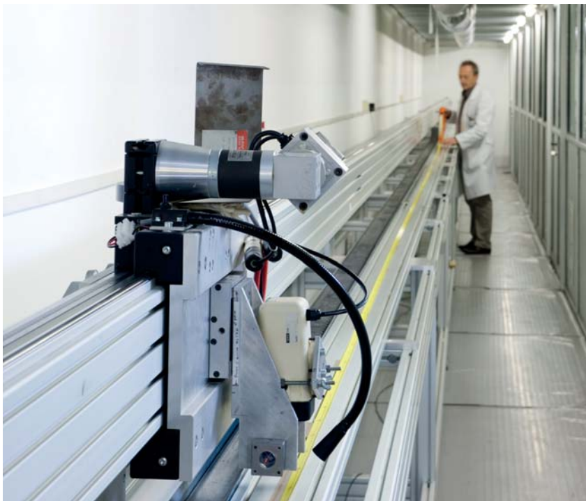
Banc de mesure tridimensionnel de grande longueur (jusqu'à 26 mètres).
