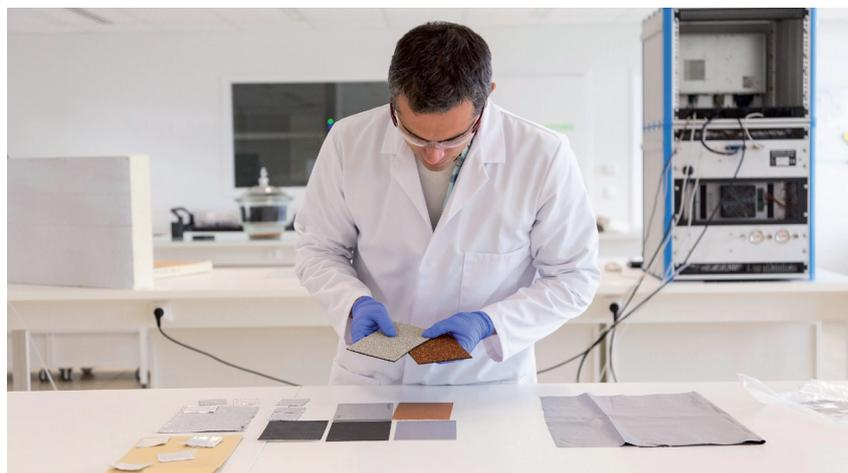
Échantillonnage de matériaux pour une analyse spectrophotomètre
