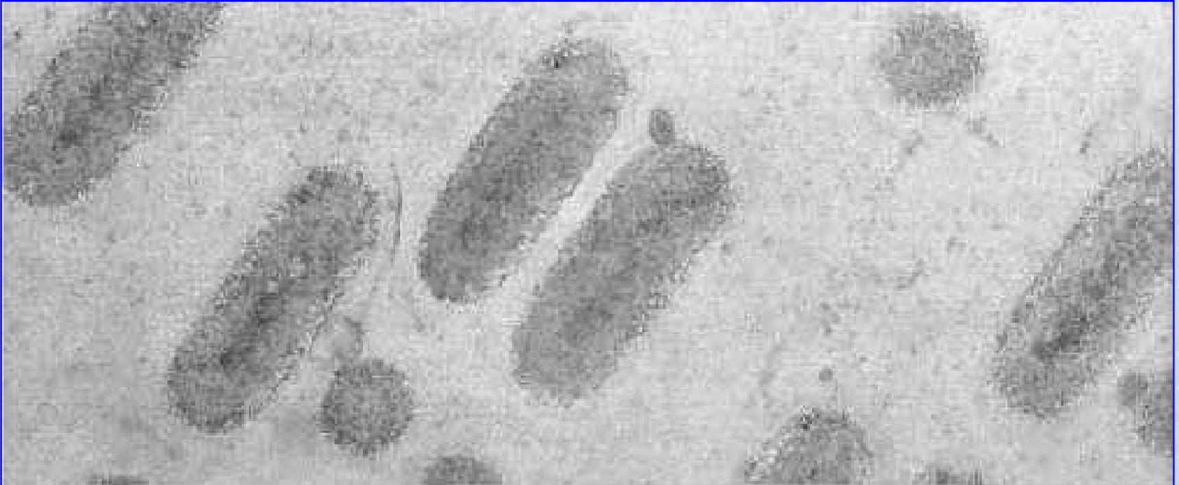
Marques formées dans une couche bi-matériau de type Silicium / Alliage Cuivre sur un BD-R inorganique TDK (document TDK / image microscope électronique à transmission)
