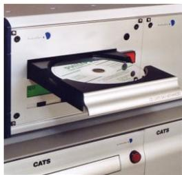
***L'analyseur, instrument clé de contrôle et d'étude des disques optiques permet de caractériser ceux-ci sur un très grand nombre de critères. Mais l'interprétation des phénomènes observés n'est pas toujours aisé ...***
