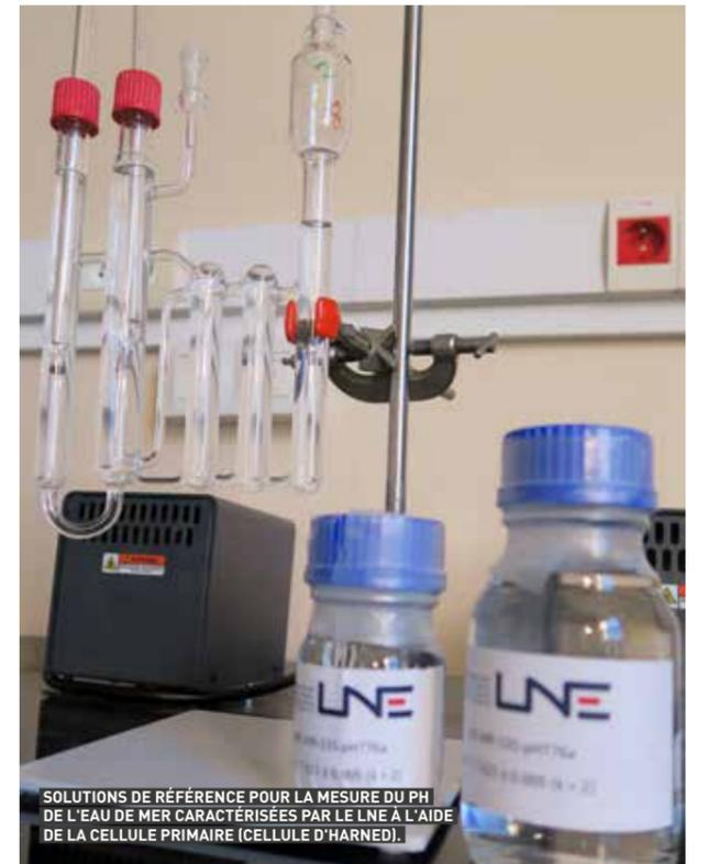
SOLUTIONS DE RÉFÉRENCE POUR LA MESURE DU PH DE L'EAU DE MER CARACTÉRISÉES PAR LE LNE À L'AIDE DE LA CELLULE PRIMAIRE (CELLULE D'HARNED).
