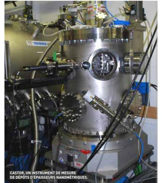
CASTOR, UN INSTRUMENT DE MESURE DE DÉPÔTS D'ÉPAISSEURS NANOMÉTRIQUES.
