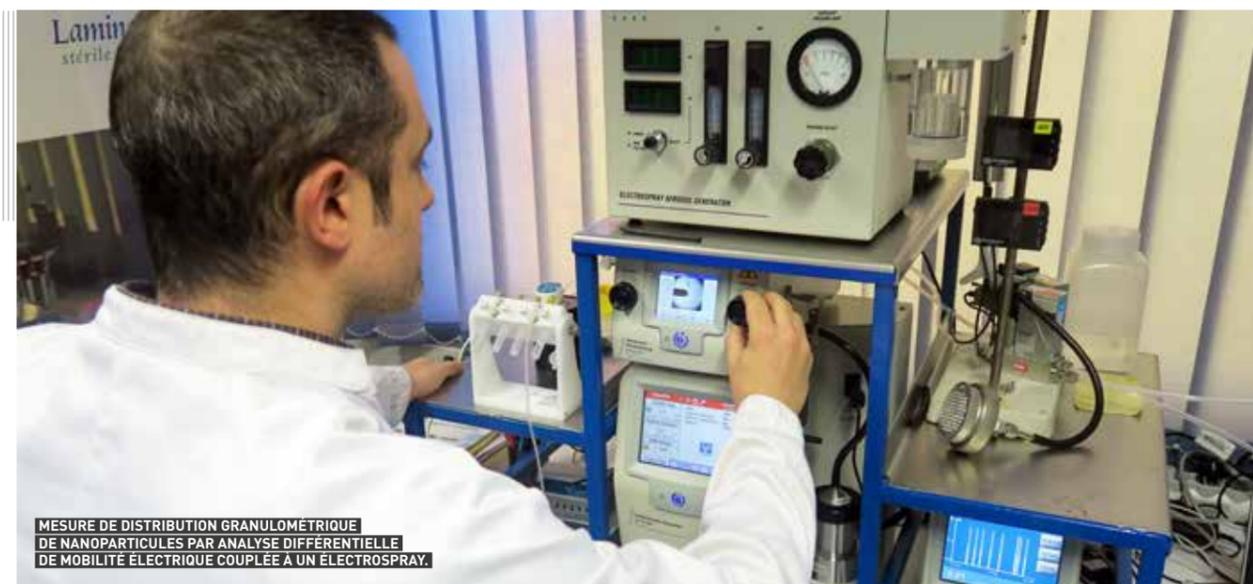
MESURE DE DISTRIBUTION GRANULOMÉTRIQUE DE NANOPARTICULES PAR ANALYSE DIFFÉRENTIELLE DE MOBILITÉ ÉLECTRIQUE COUPLÉE À UN ÉLECTROSPRAY.
