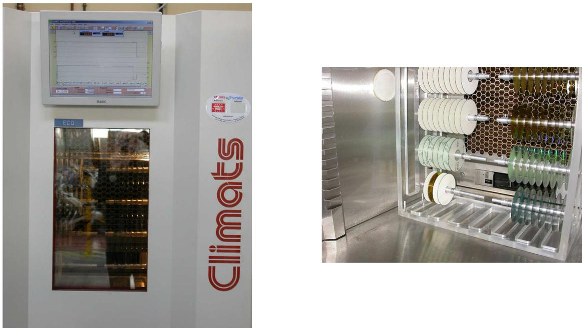
Le choix des valeurs de la température et du taux d'humidité s'appuie sur les conditions définies comme possibles dans la norme ISO / CEI 16963 relative à l'évaluation de la durée de vie des disques optiques. La plupart des essais réalisés au LNE l'ont été avec une température de 80°C (maximum dans la norme : 85°C) et un taux d'humidité relative de 80% ou 85%.
