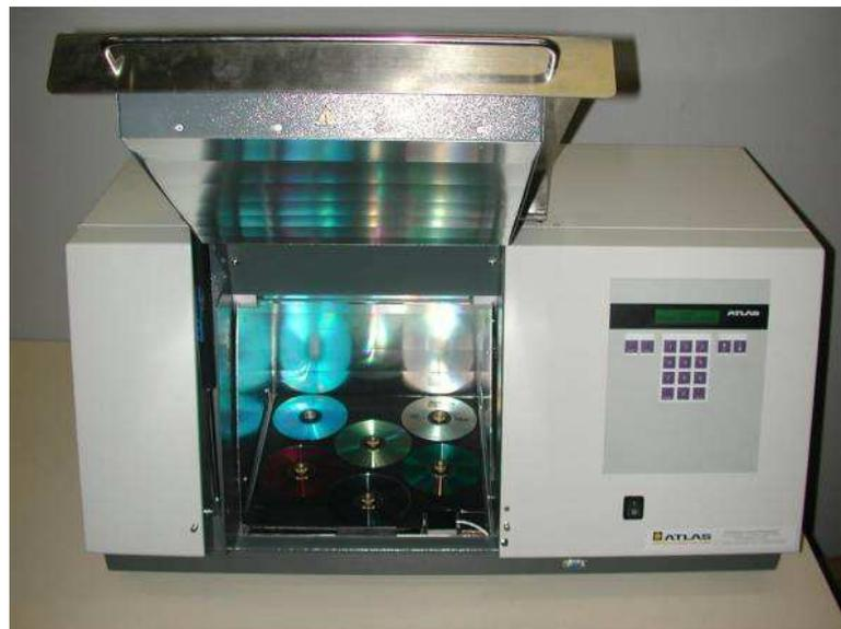
Cet appareil est équipé d'une lampe à arc au xénon de 2200 W. Des filtres infrarouges et ultraviolets sont utilisés pour que le spectre de la lumière se rapproche du spectre solaire filtré par une vitre, comme c'est le cas à l'intérieur des locaux. Le spectre de la lumière émise à l'intérieur de l'enceinte est montré sur la figure 6.2.
