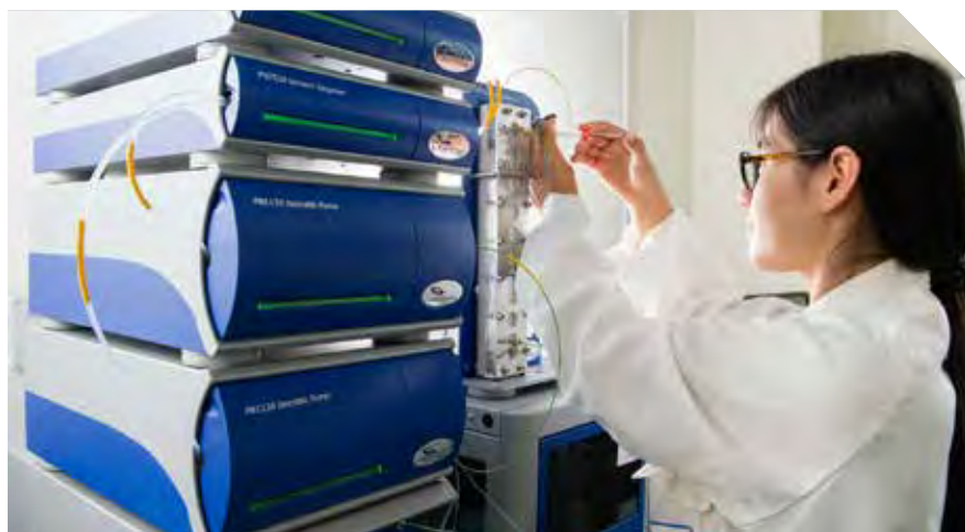
Plateforme de caractérisation des nano-objets en phase liquide du LNE : chaîne A4F et ses détecteurs UV, réfractomètre et diffusion de lumière, MALS
