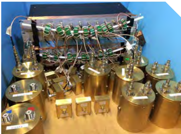
Capacité étalon programmable composée de condensateurs étalons de 10 aF à 100 fF associés à un multiplexeur coaxial 20 voies.
