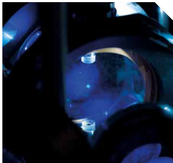
Gros plan du cœur d'une horloge optique à atomes de strontium.
