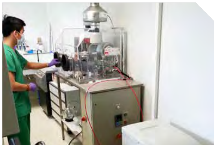
Banc d'abrasion mécanique couplé à une chambre d'exposition par inhalation (Anses).
