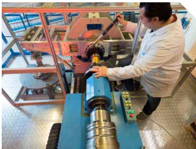
Montage d'un couplemètre dans le nouveau banc LNE-LCM de référence de couple de 5 kN.m.
