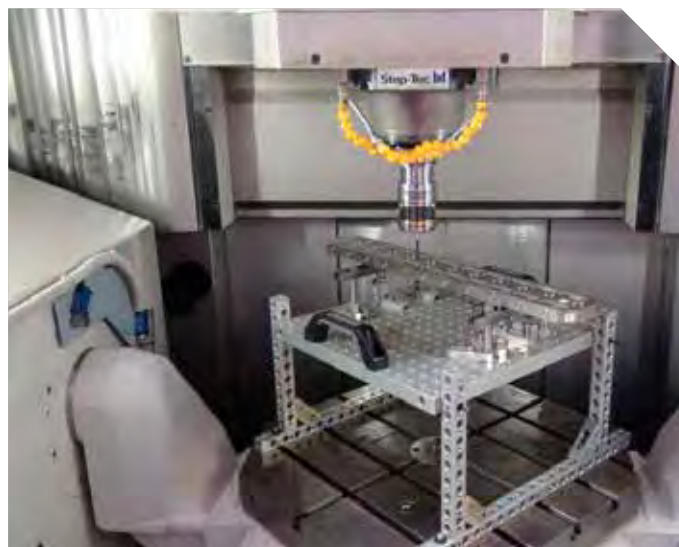
Qualification d'une machine-outil à commande numérique via une barre à trous améliorée.
