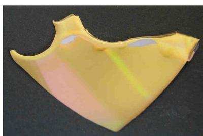
Figure 2.3. Couche réfléchissante en or extraite d'un CD-R MPO
