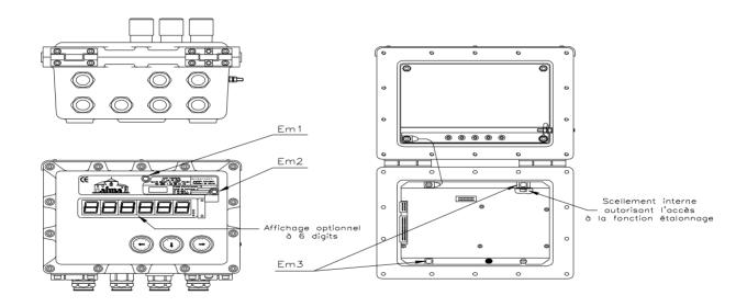
Plan de scellement, version dispositif de scellement externe
