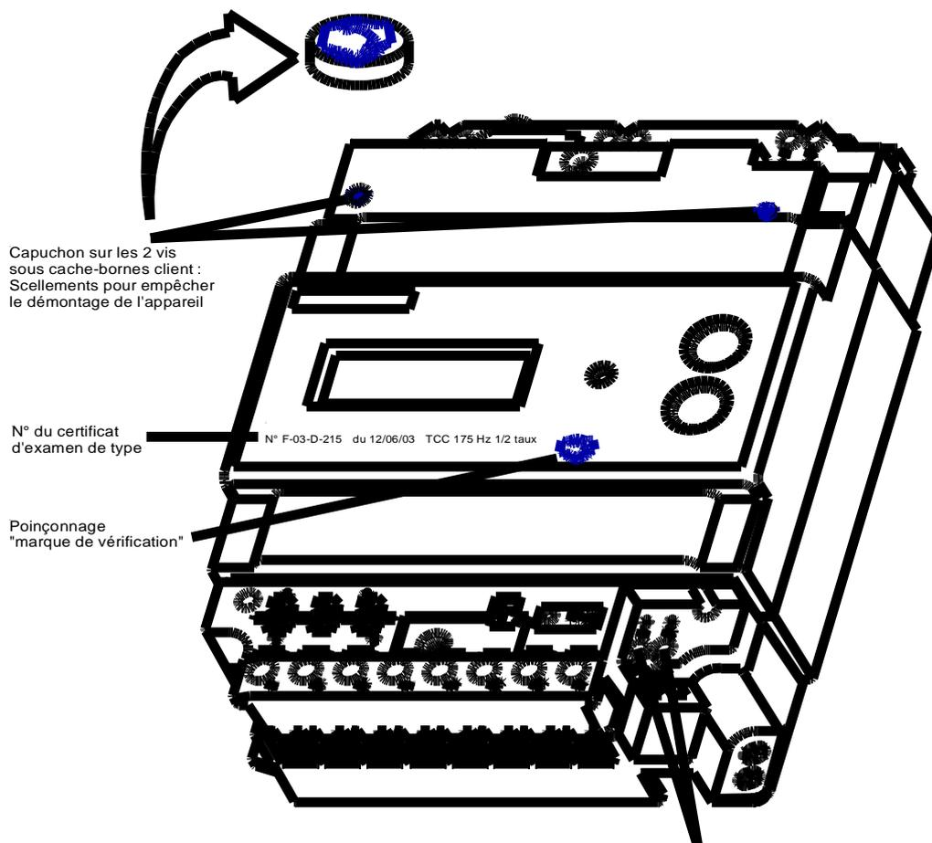
Après calibration du compteur par les bornes de sortie téléreport T1 et T2, l'accès au moniteur est interdit par un verrouillage électronique
