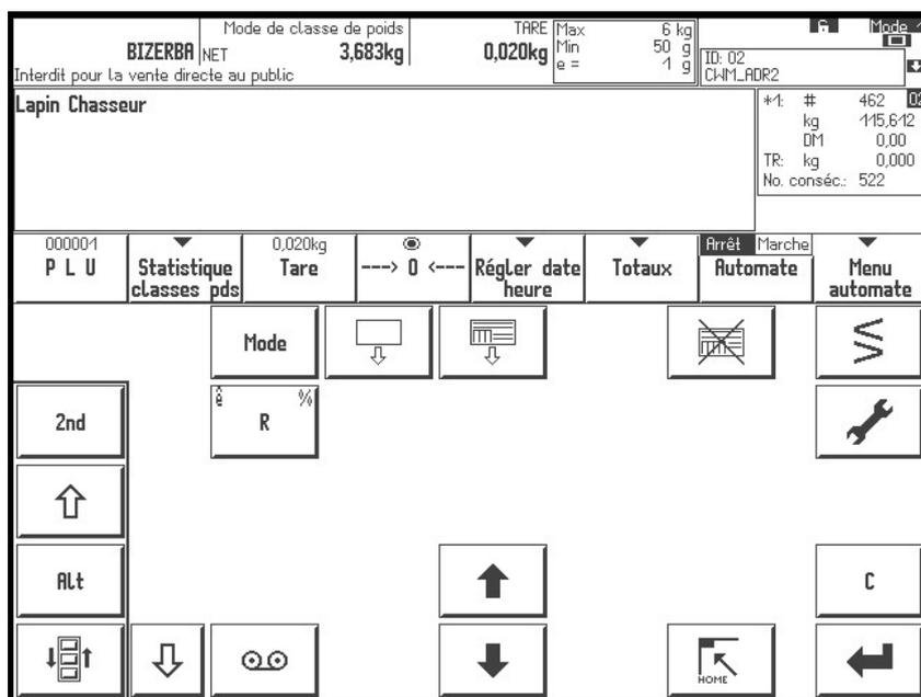
Zone de commandes matérialisées par des touches apparaissant sur l'écran
