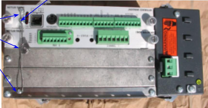
**Boîtier de jonction des capteurs**
