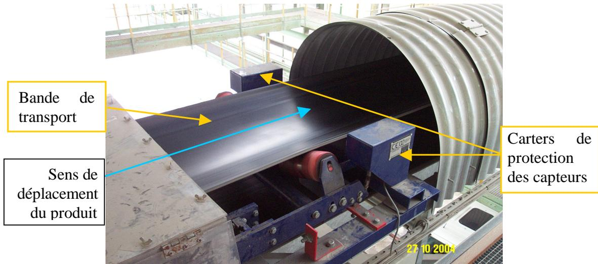
Schéma de la partie mécanique
