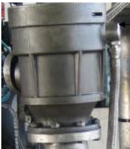
Dispositif de scellement du capteur de proximité type N4020 équipant le coupleur ALMA type S02
