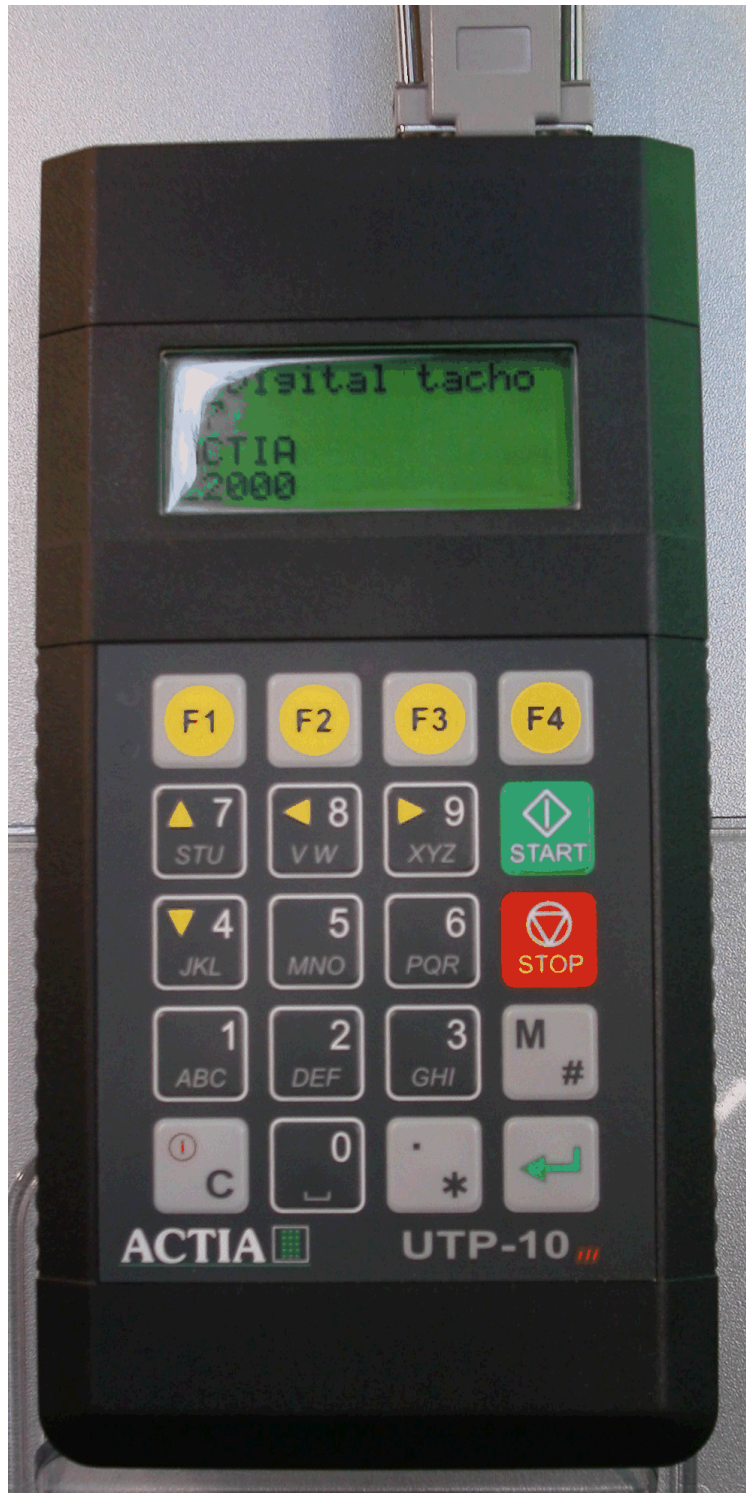
Terminal portable UTP-10 du variateur de vitesse et banc à rouleaux MULLER Bem type SmarTach Tester
