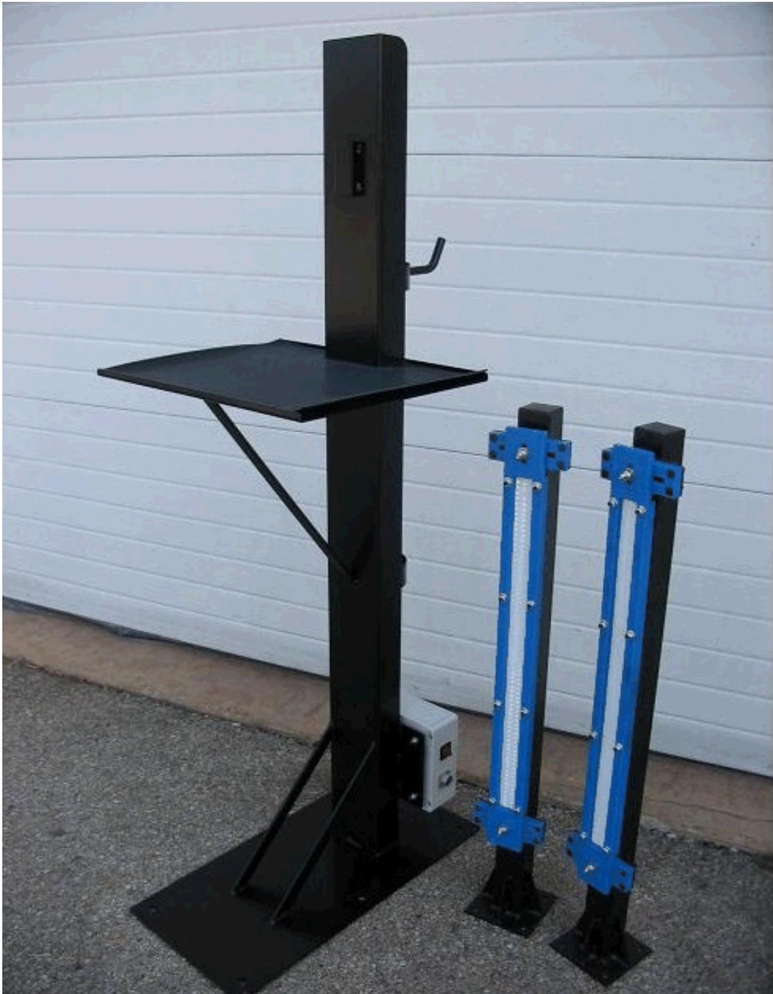
**Pupitre de commande et barrières réfléchissantes du variateur de vitesse et banc à rouleaux FLIP TECHNOLOGY type DIGITACHYTEST**
