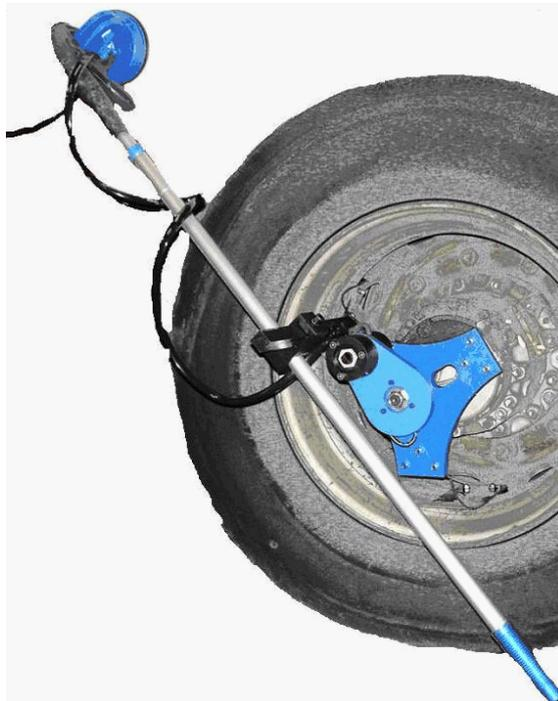
**Système codeur / cellule laser équipant le moyen d'essai
