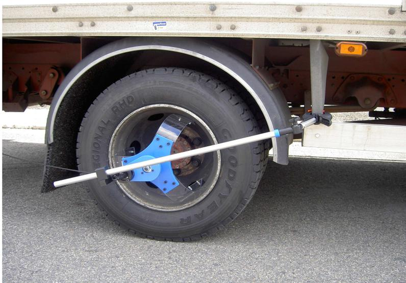
**Codeur équipant la roue droite du véhicule**
