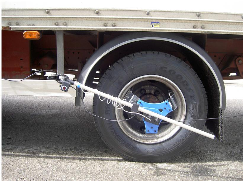
**Système codeur / cellule laser équipant la roue gauche du véhicule**
