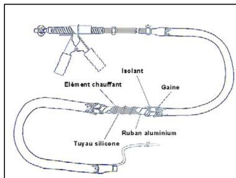
Longueur totale de la ligne de prélèvement :  $L = 2345 \text{ mm} \pm 5\%$  (soit 2228 mm à 2462 mm).
