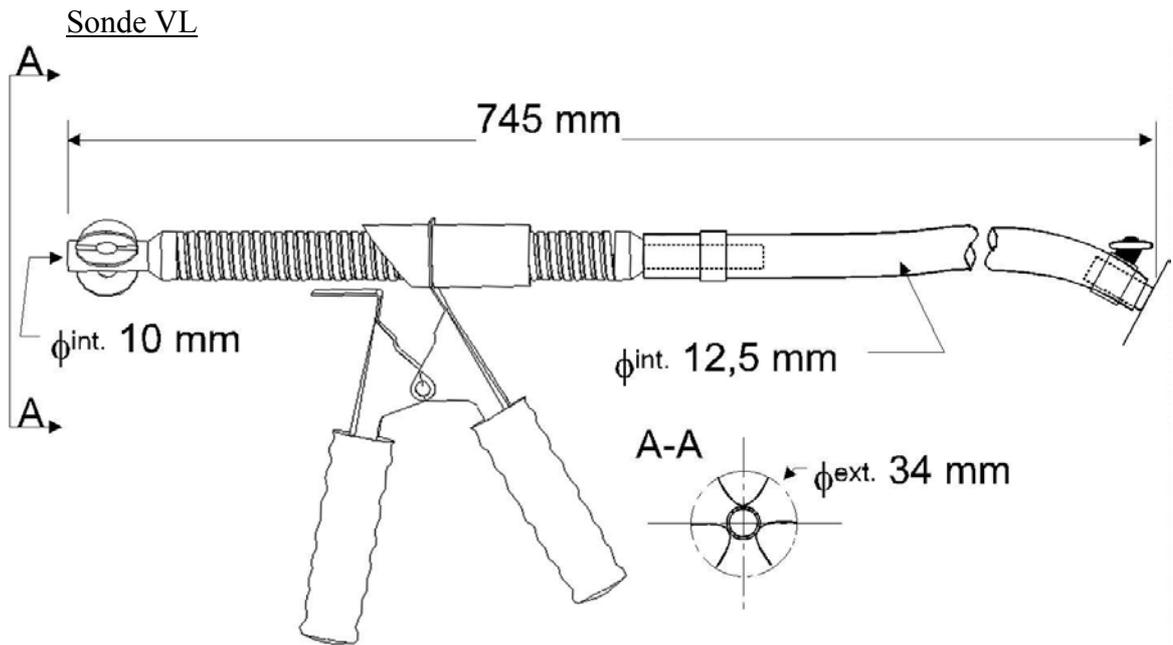
Sonde de prélèvement CAP10
