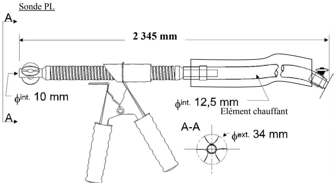
Sonde de prélèvement CAP10-PL
