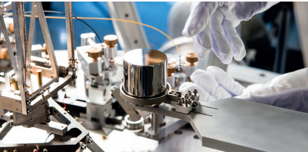
Redéfinition du kilogramme : balance du watt du LNE utilisée pour obtenir la valeur de la constante de Planck.
